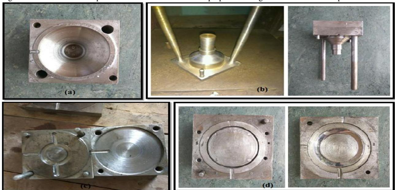
**Fig. 18** (a) Cavity Plate (b) Core Plate (c) Relief on Parting Surface (d) Baffle Circular Cooling Channel
